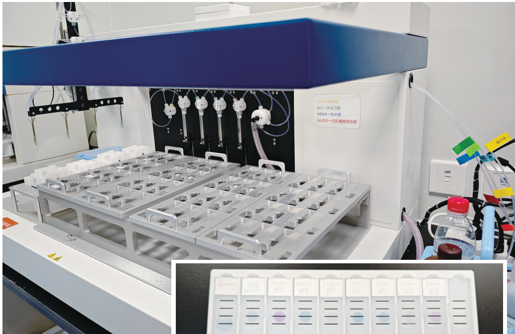
▲BD全自动液基细胞制片仪。 ▶BD液基细胞制片仪所制的制片(上)与人工制片(下)对比图。
