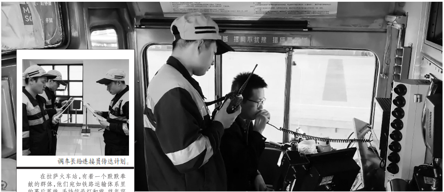
调车长和调车司机正在做灯显试验。
