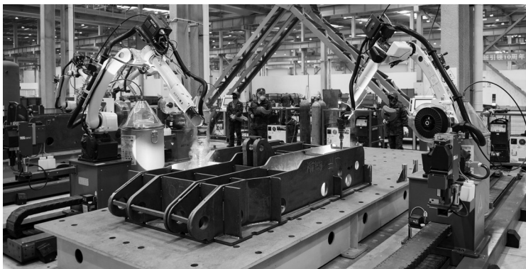
在位于贵州省六盘水市高新区内的一家装备制造企业生产车间,机械手臂进行焊接作业。 新华社发 尚宇杰摄
