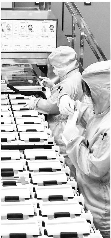
在广西柳州市瑞浦赛克动力电池有限公司电芯装配车间,工人进行目检工序。 新华社记者 金皓原 摄
