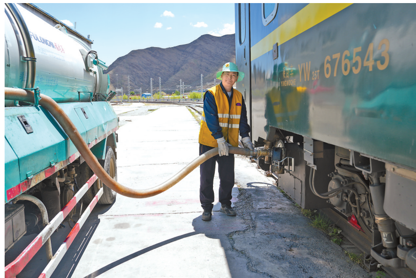
图为工作人员正在开展吸污作业。
