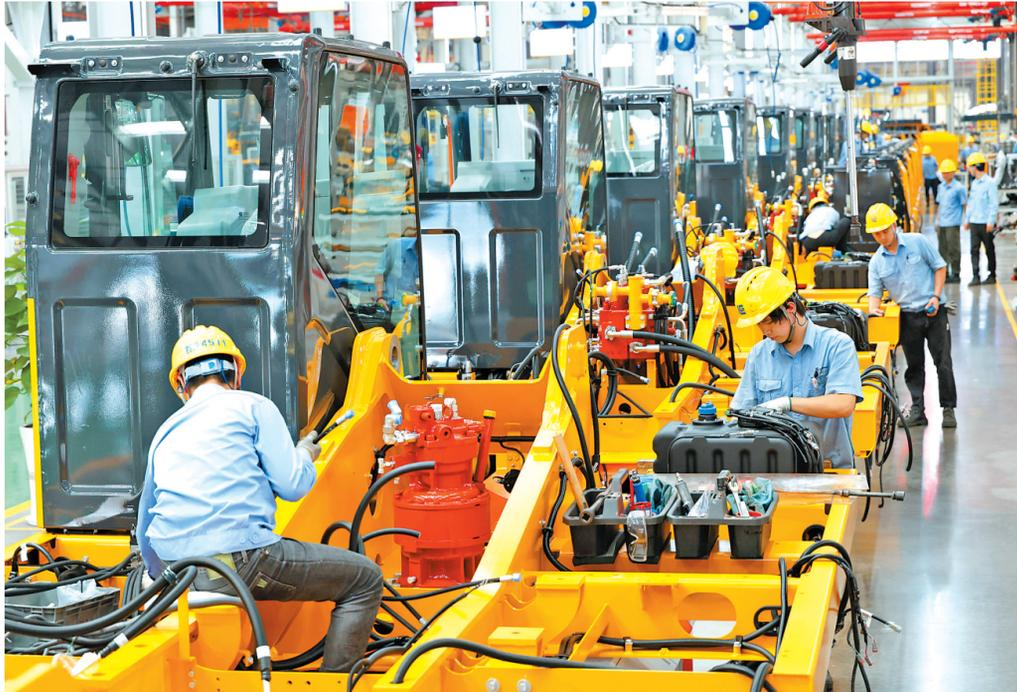
图为在柳工挖掘机智慧工厂拍摄的挖掘机上部机构件组装机(2024年11月12日摄)。
