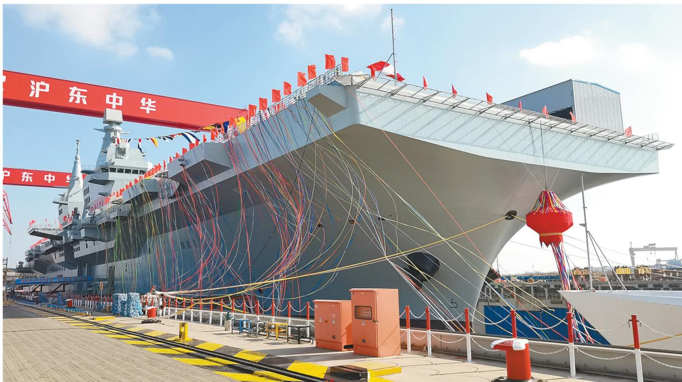
经中央军委批准,076两栖攻击舰首舰命名为“中国人民解放军海军四川舰”,舷号为“51”。四川舰满载排水量4万余吨,设置双舰岛式上层建筑和全纵通飞行甲板,创新应用了电磁弹射和阻拦技术,可搭载固定翼飞机、直升机、两栖装备等,是海军新一代两栖攻击舰,是推进海军转型建设发展、提升远海作战能力的关键装备。该舰下水后,将按计划开展设备调试、系泊试验、航行试验等工作。
