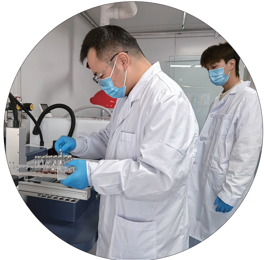
图为司法鉴定人员正在进行样本血液内乙醇鉴定进样操作。
