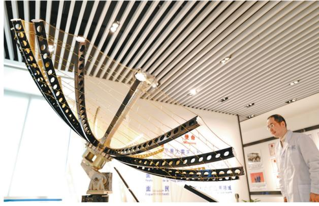
在东华大学纺织面料技术教育部重点实验室拍摄的鹊桥二号星载天线缩比模型(4月2日摄)。
